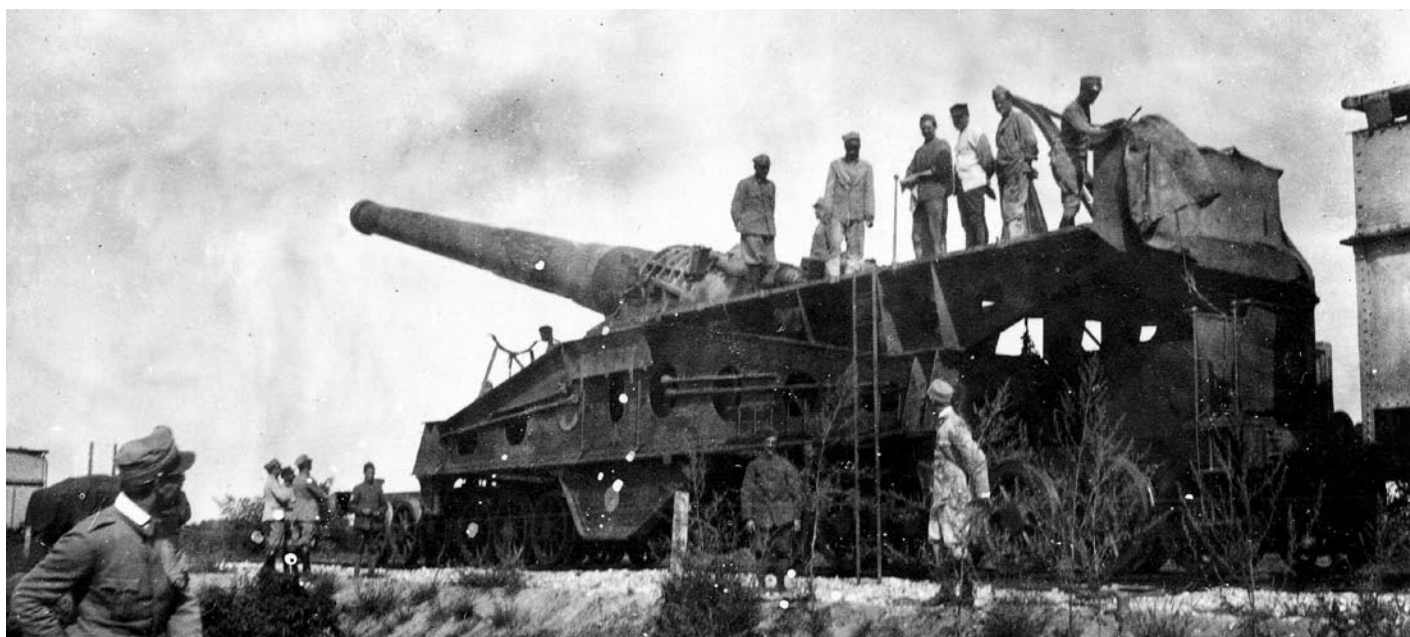
Questa foto, scattata in data a noi sconosciuta nelle retrovie del fronte isontino, ritrae militari Italiani e Francesi intenti ad allestire un cannone di grosso calibro su affusto ferroviario. L'arma, di costruzione francese, aveva un peso complessivo di 164 tonnellate ed una canna da 340 mm di calibro, lunga 15,3 metri e capace di sparare proiettili pesanti 432 Kg a 44 Km di distanza. La 44 a Squadriglia di Gonars, nel mese di agosto 1917, eseguì delle missioni di direzione del tiro per cannoni di questo tipo. (Foto Valentino Gigante via Tiliaventum)
