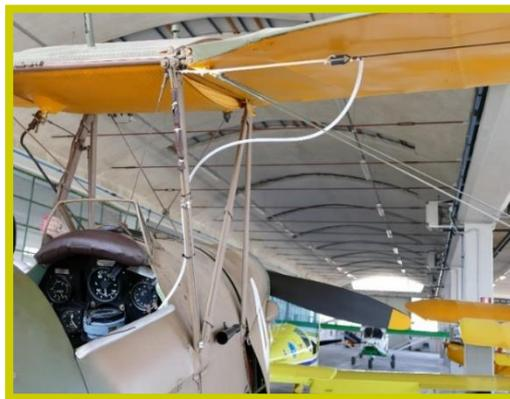
Foto N° 16 isolatore elettrico e tubo isolante fascettato al montante Interlare per fare entrare nell'abitacolo il cavo d'antenna
