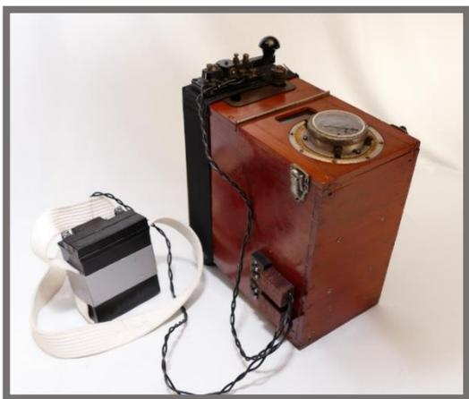
Foto N° 12 la Marconcina con batteria da 12 Volt e tasto telegrafico fissato con elastico
