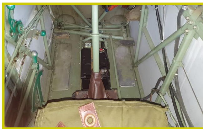
Foto N° 14 interno della cabina, tiranti di comando, cloche, pedaliera
