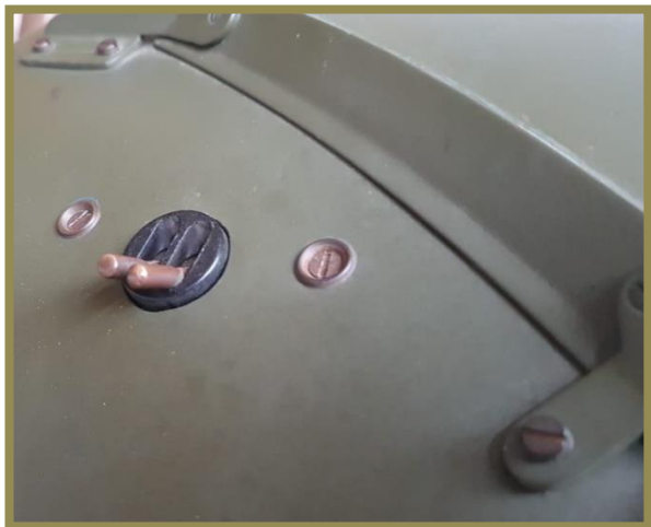
Foto N° 27 interruttori per i magneti
