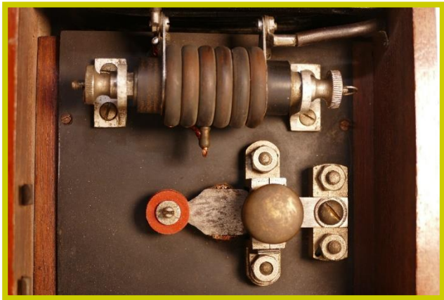
Foto N° 9 spinotto utilizzato per utilizzare 4, 5 o 6 dischi
