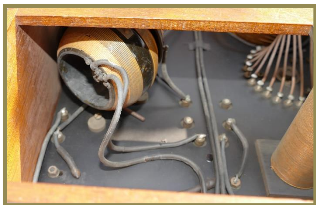
Bobina del circuito primario azionata dal comando intensificatore
