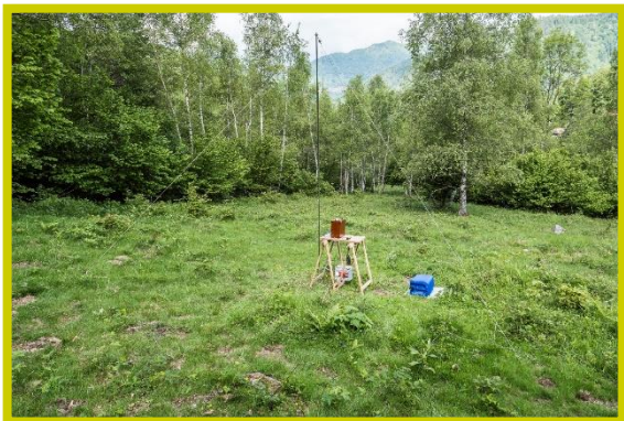
Foto N° 5 postazione con Marconcina collegata all'antenna filare, a terra il bidone per creare la terra fittizia
