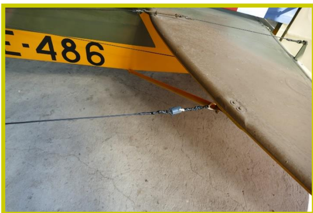
Foto N° 21 isolatore collegato al piano di coda
