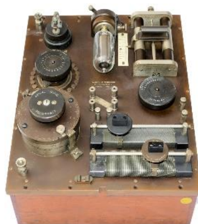
Ricevitore OMNIBUS della Stazione Radiotelegrafica da 1,5 kW Carreggiata. Marconi Wireless Telegraph Co Ltd –
