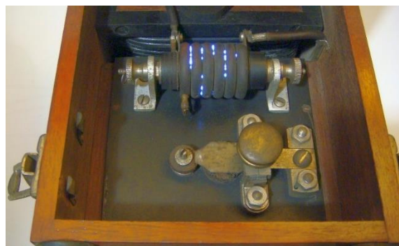
Foto N° 8 scaricatore a 6 dischi tutti collegati
