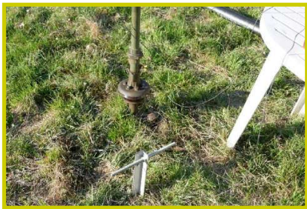
Foto N° 6 picchetto di terra e base dell'antenna del ricevitore Omnibus
