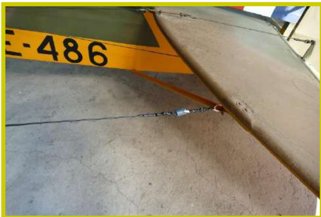
Foto N° 21 isolatore collegato al piano di coda
