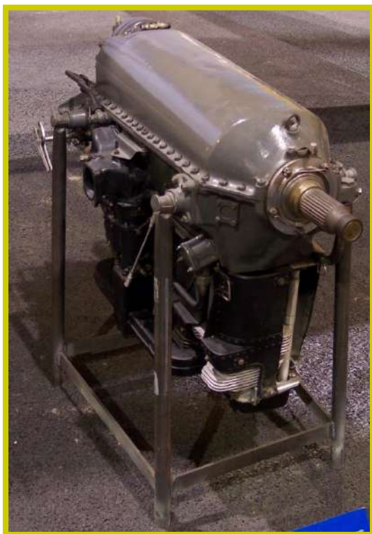
Foto N° 12 il 4 cilindri in linea raffreddato ad aria del Tiger Moth.
