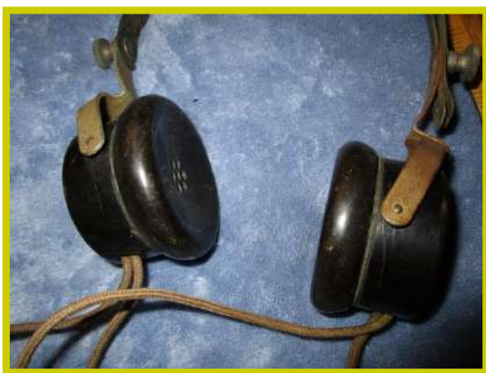
Foto N° 10 Cuffie Baldwin collegate al ricevitore Omnibus
