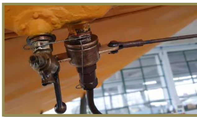
Foto N° 26 Rubinetto della benzina posizionato sotto al serbatoio e relativo tirante di comando
