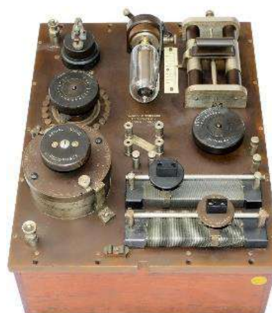
Ricevitore OMNIBUS della Stazione Radiotelegrafica da 1,5 kW Carreggiata. Marconi Wireless Telegraph Co Ltd –
