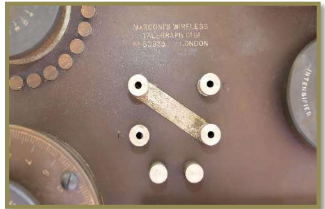
Reofori utilizzati per collegare una cuffia oppure due cuffie in serie.
