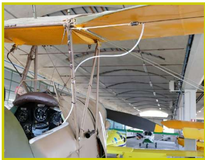
Foto N° 24 tubo di plastica isolante, fascettato sui montanti interalari usato per fare entrare il cavo d'antenna nell'abitacolo
