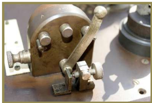
Particolare del commutatore per utilizzare il carborundum in posizione C oppure il diodo in posizione V. Si noti anche lo scaricatore d'antenna micrometrico a protezione dei circuiti del ricevitore.
