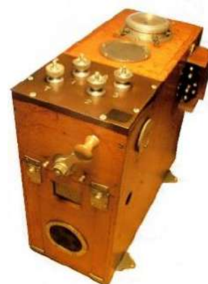
Trasmittitore da aeroplano – 1914 -1918 Officine Marconi - "MARCONCINA".
