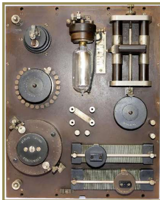
Partendo dall'alto e scendendo in basso troviamo in posizione centrale una replica del diodo di Fleming con attacco a vite.
