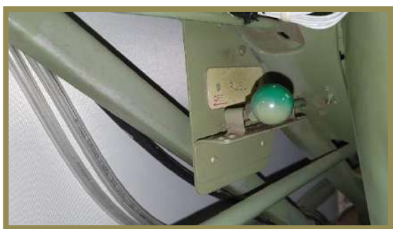
Foto N° 25 Leva FUEL per l'apertura del rubinetto della benzina
