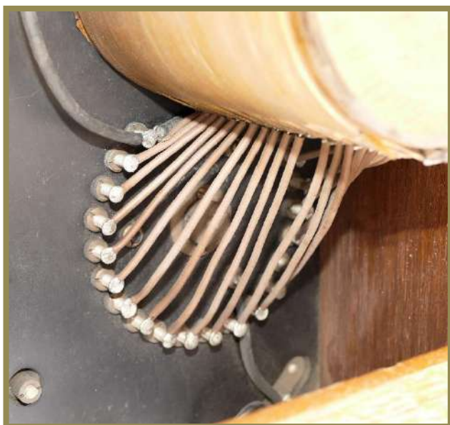
bobina del circuito d'aereo con 21 terminali collegati al commutatore d'aereo
