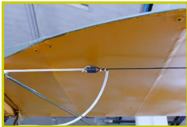
Foto N° 23 ultimo isolatore posizionato sotto l'ala superiore, sopra all'abitacolo dell'osservatore.
